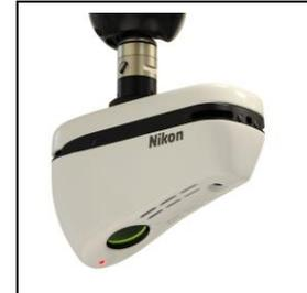
Alle Genauigkeitsspezifikationen gelten für ein KMG mit einer Genauigkeit von 2 µm + L/350 oder besser unter Verwendung einer vom Hersteller gelieferten Kalibrierkugel
