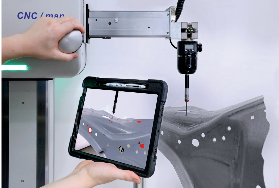
Geführte Messung mit Hilfe des AR-Moduls
